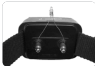
Sposób przymocowania lampki testowej
